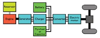
Fig. 3. Parallel hybrid powertrain
